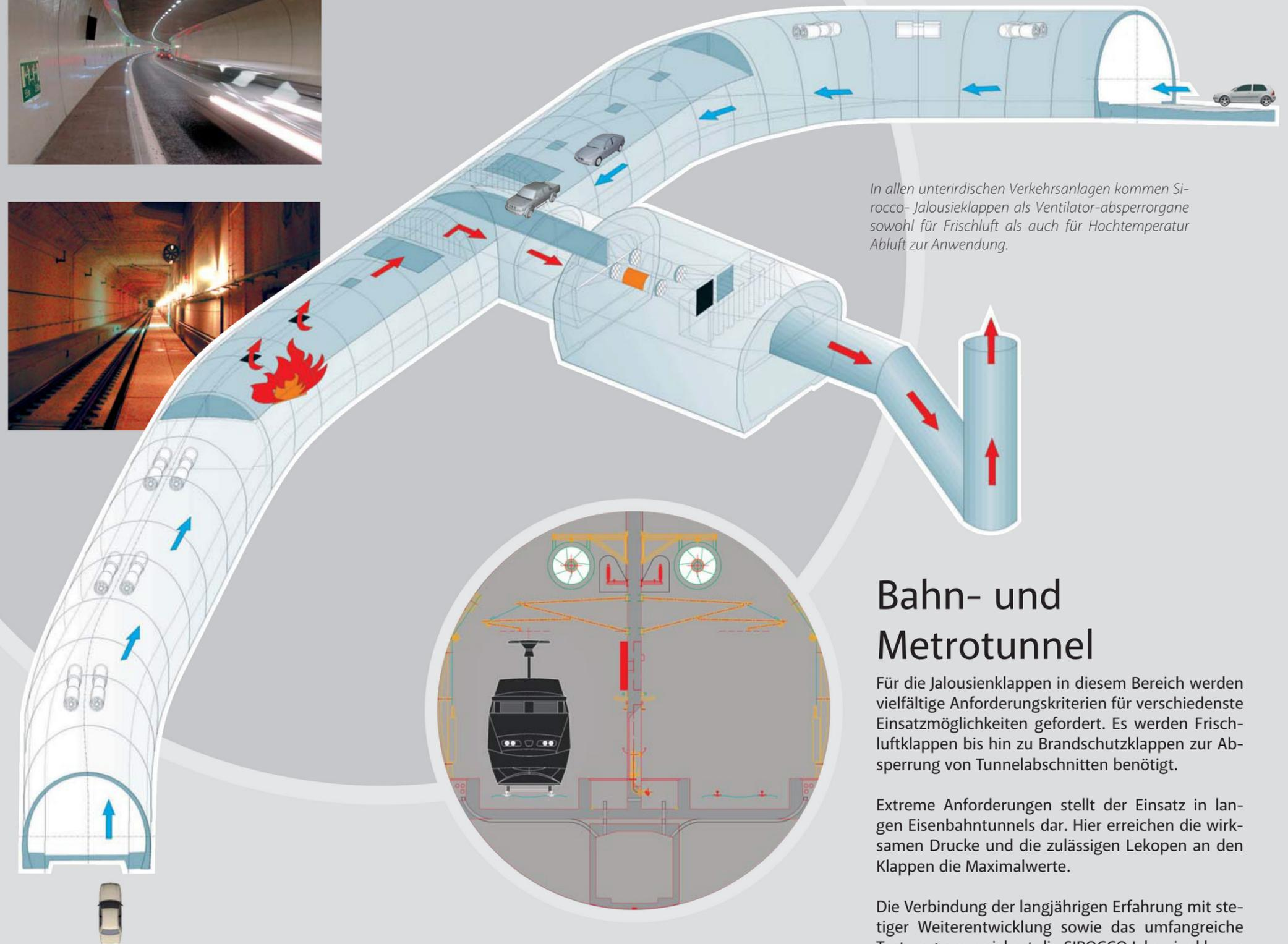
*In allen unterirdischen Verkehrsanlagen kommen Sirocco- Jalousieklappen als Ventilator-absperroorgane sowohl für Frischluft als auch für Hochtemperatur Abluft zur Anwendung.*
